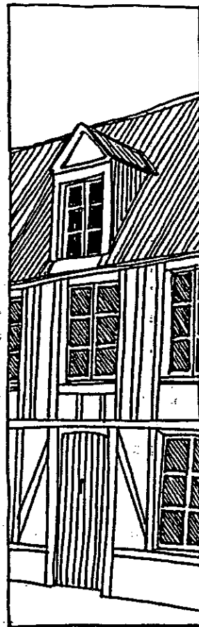
LUCARNE EN BÂTIÈRE
