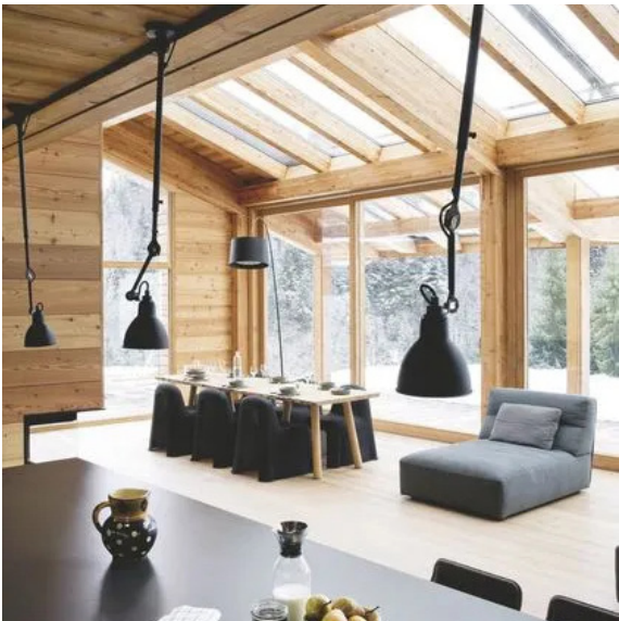
Construction d'une grange contemporaine Les Carroz d'Arraches Volumes simple / Intégration des ouvertures en toiture dans la charpente / Réalisation d'une façade entièrement vitrée / Construction en ossature bois
