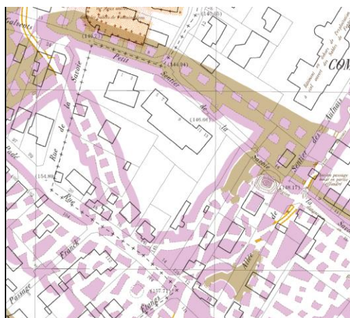
Figure 27 : extrait de la carte 18-60 de l'Atlas des carrières montrant une petite partie de la carrière des Galvents (Doc IGC)
