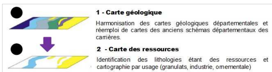
Figure 3 : Séquences de traitement des ressources minérales primaires
