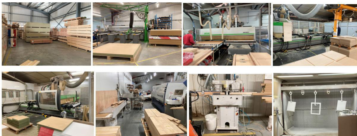
Figure 3 : Ligne de production actuelle, flux trappes. De gauche à droite : Absence de moyen de stockage optimal ; scie à panneaux ; usinage Excel ; Rover ; Moulurière ; ilot contre-cadre ; tunnel de laquage
