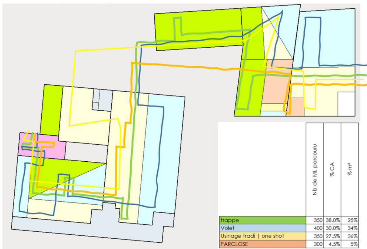
Figure 2 : Flux générés sur la ligne de production actuelle
