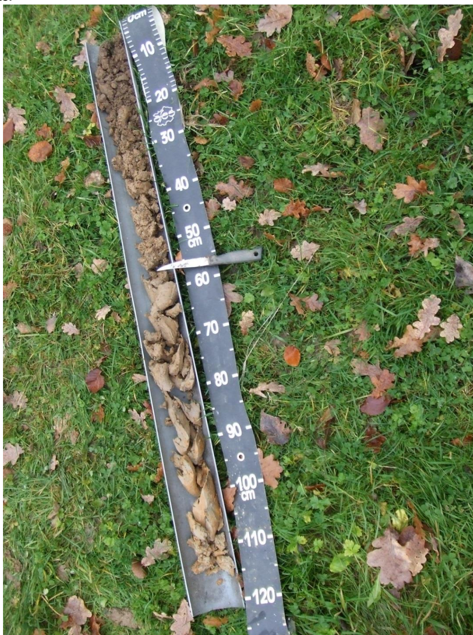
Photo 2. Vue sur un sondage de type All n°2 à texture limono-argileuse à argileuse se rapportant à la classe de sol Vb
