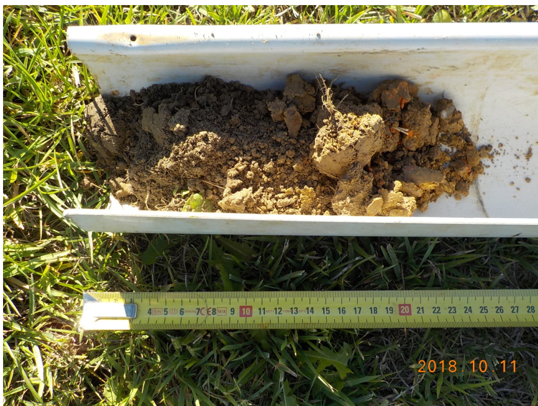
Exemple du PSC1 (non humide sur la profondeur d'investigation)
