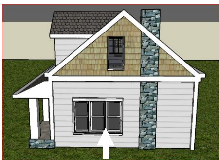
Substruction apparente traitée à l'identique du reste de la façade
