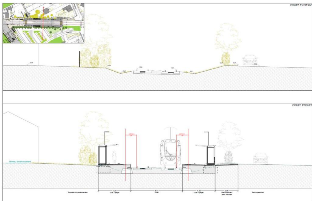
Figure 4 : Station de Bailly – coupe de la station
