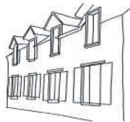
Les ouvertures ne sont pas inscrites aléatoirement dans la façade, les linteaux sont alignés et sont souvent cintrés
