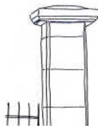
Tête de pilier en pierre de taille pour une clôture
