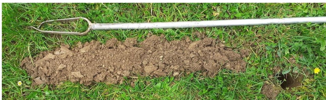
Sondage S46 montrant un sol limoneux moyennement profond, de couleur marron, sans traces d'hydromorphie
