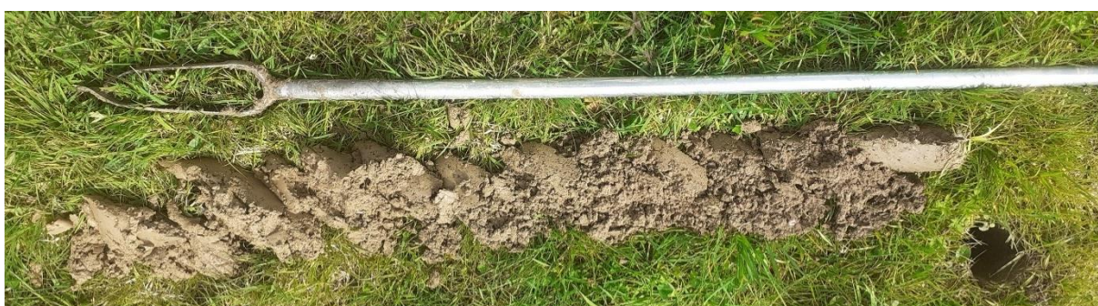
Sondage S99 : Sol limoneux moyennement profond, devenant légèrement grisâtre en profondeur
