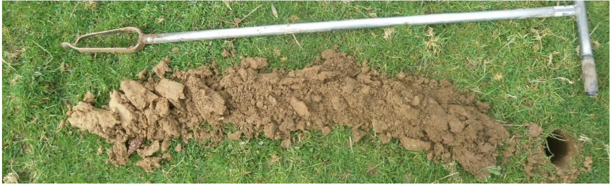
Sondage S94 montrant un sol limoneux moyennement profond, de couleur marron devenant plus clair en profondeur
