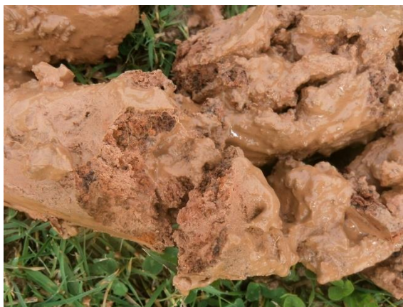
Sondage S15 : Argile limoneuse, bariolé rouge / marron rougeâtre à partir de 90 cm de profondeur ; observation de la texture pâteuse
