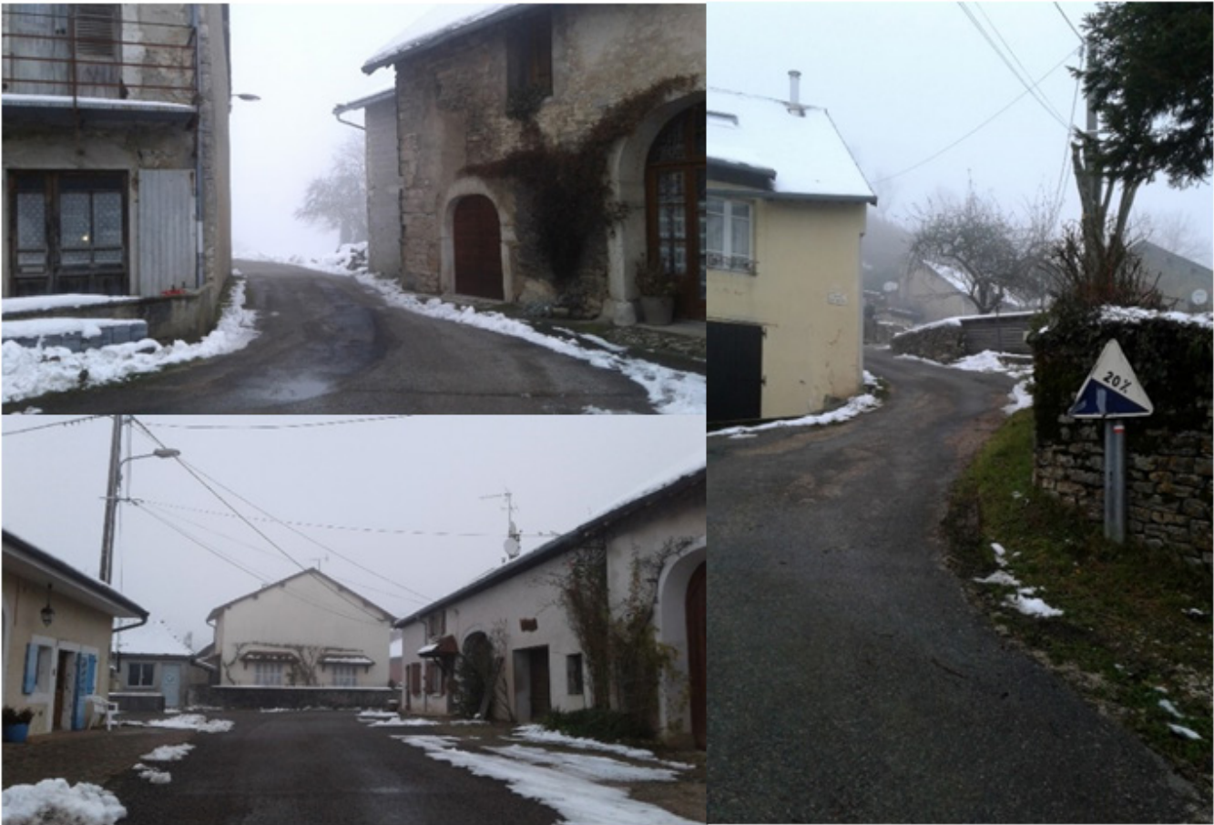
Villages de Sarroгна (Nermier et Marangea) et de la Chailleuse (Saint Laurent la Roche) : l'étréitesse des passages due à la proximité du bâti, les angles serrés ainsi que les fils électriques et téléphoniques limitent fortement l'accès aux grumiers et leurs manœuvres. Ces passages peuvent cependant être nécessaires pour accéder à la forêt et en sont parfois les seuls accès possibles.
