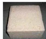
Pavés en béton poreux
