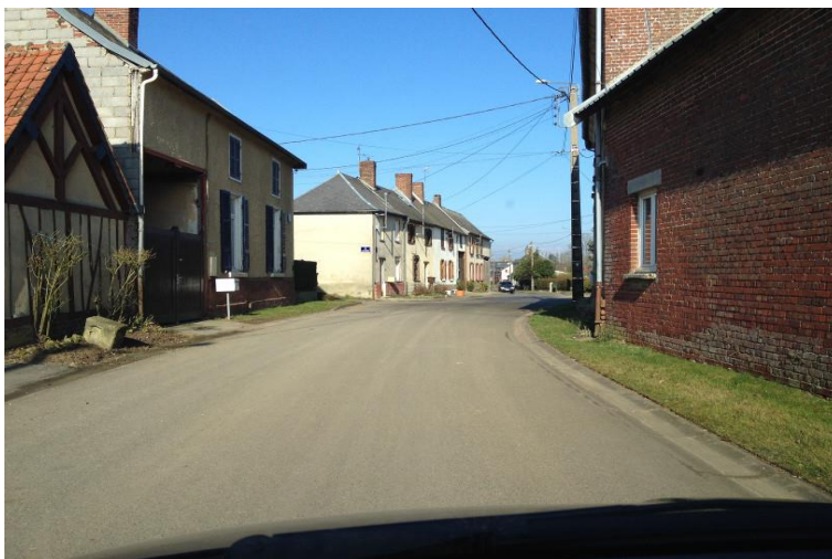
Caniveau collectant les EP, trottoirs enherbés
