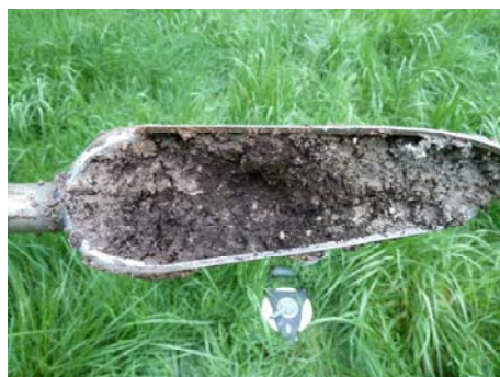
Sondage BACS 21 – détail de l'horizon de tourbe
