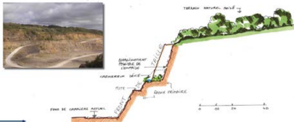
Coupe de principe sur nouveau tracé du Crembreux
