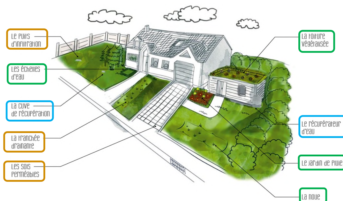
Figure 15 : Techniques de gestion des eaux pluviales à la parcelle (source : ADOPTA)
