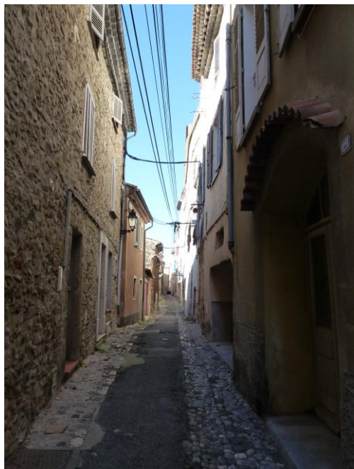
Rues parallèles à la pente: des voies horizontales et planes réalisées pour le passage des animaux et des charettes
