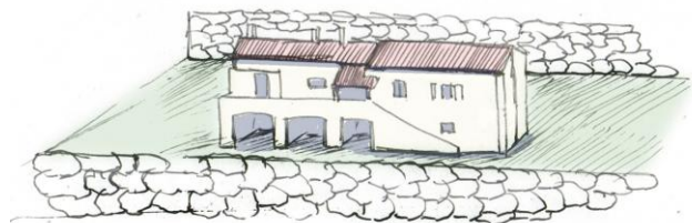
A éviter : soutènement et enrochements trop imposants
