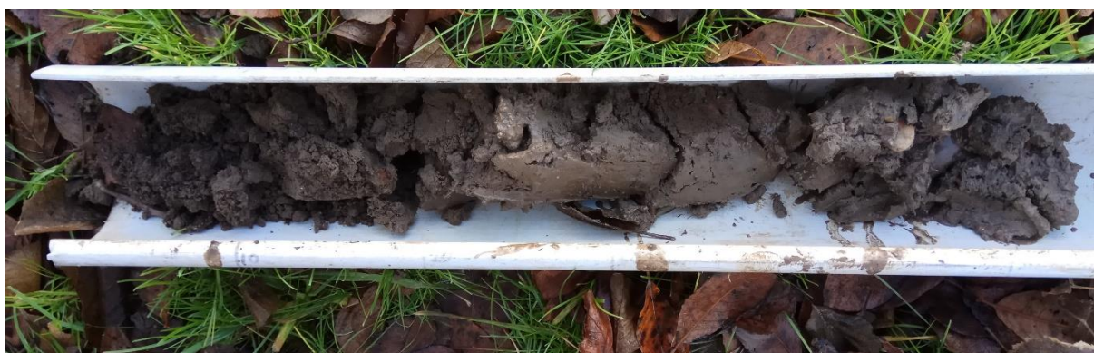
Figure 6 : Sol de zone humide : réductisol avec hydromorphie débutant avant 25cm de profondeur
