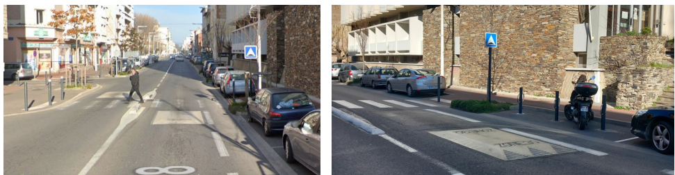
Avenue Maréchal Joffre (Perpignan) : passage piéton avant neutralisation du stationnement en amont sur la photo de gauche (Google Maps, 2021) et après sur la photo de droite (Mairie de Perpignan, 2025). Le stationnement automobile a été remplacé par du stationnement cyclable utilisé aussi par les utilisateurs de deux-roues motorisés.
