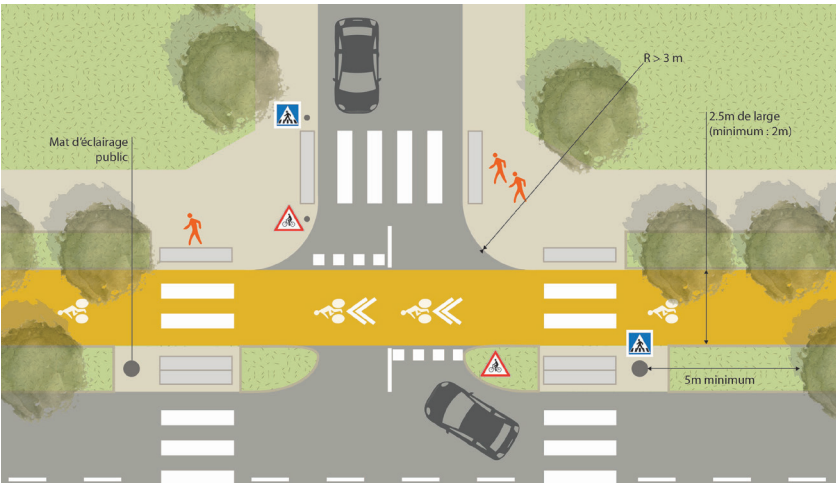
Principes d'une traversée cyclable en agglomération. Elle peut être surélevée et au même niveau que les trottoirs. Elle peut aussi être au même niveau que la chaussée mais la piste en elle-même devra être au niveau de la chaussée pour éviter les dénivellations au niveau des intersections. Illustration proposée par le CEREMA en 2021 (AURCA, 2024).
