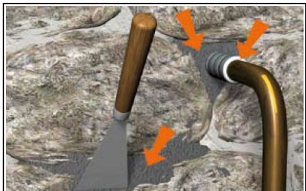
Situation après travaux de colmatage
