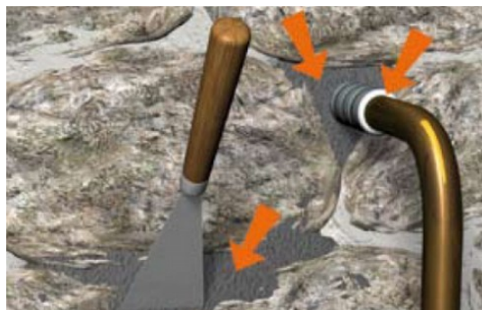
Situation après travaux de colmatage
