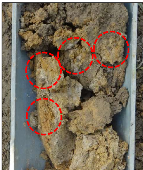
Figure 12 : Sondage n°2 – traces d'oxydation aux environs de 20 cm de profondeur (recouvrement >5%)
