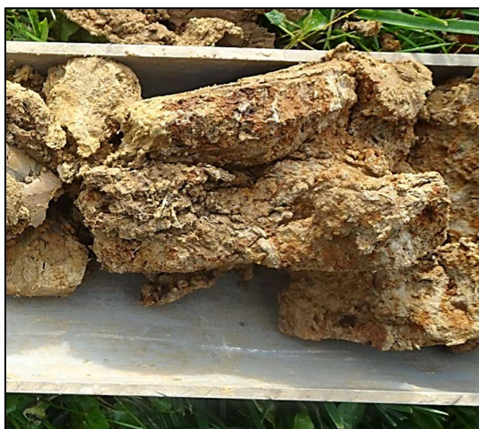
Figure 12 : Sondage n°2 – traces d'oxydation aux environs de 50 cm de profondeur (recouvrement >5%)
