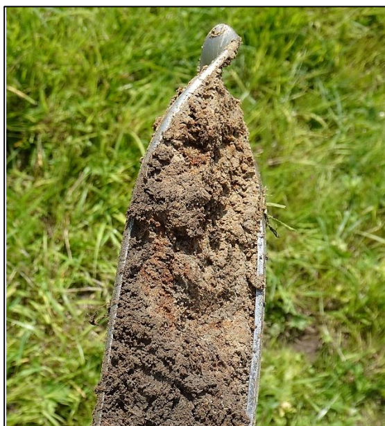
Figure 9 : Sondage n°1 – traces d'oxydation aux environs de 20 cm de profondeur (recouvrement >5%)
