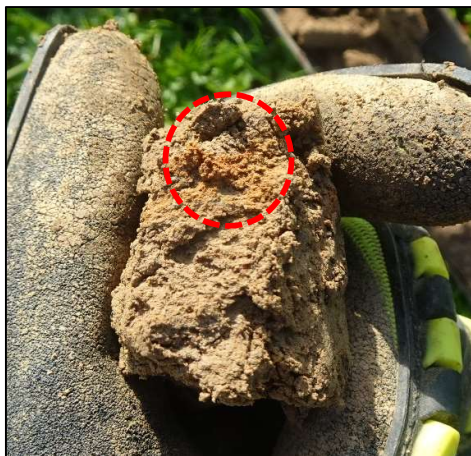
Figure 13 : Sondage n°1 – traces d'oxydation aux environs de 60 cm de profondeur (recouvrement >5%)
