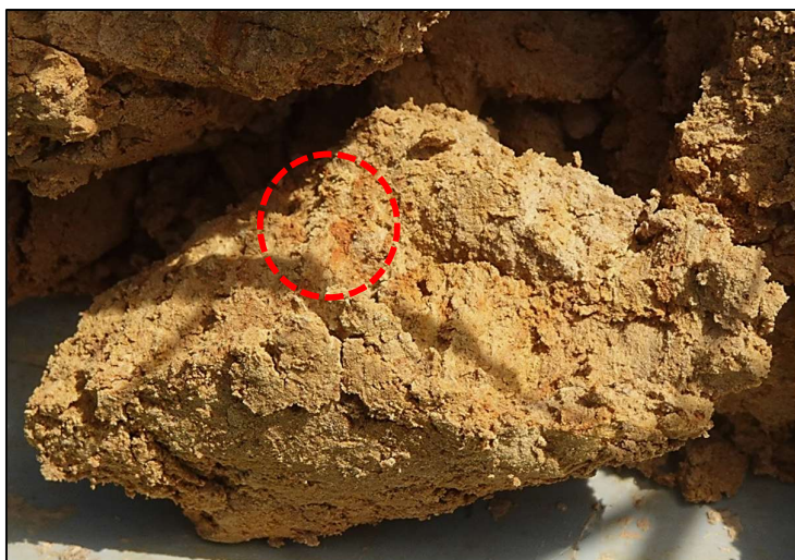
Figure 13 : Sondage n°1 – traces d'oxydation aux environs de 70 cm de profondeur (recouvrement >5%)
