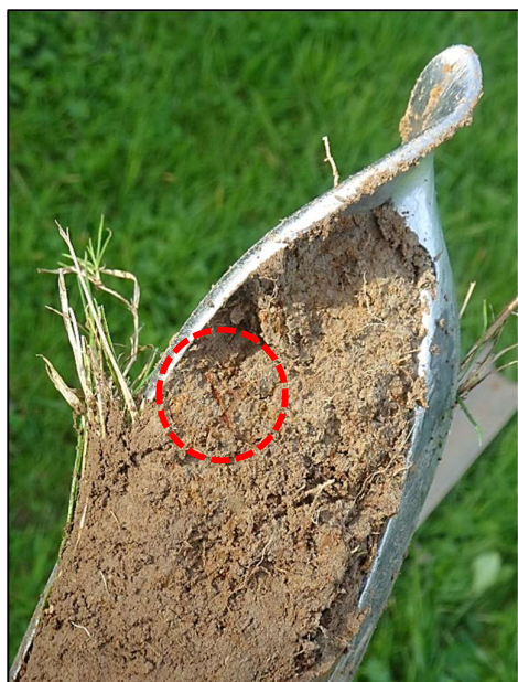
Figure 13 : Sondage n°7 – traces d'oxydation aux environs de 50 cm de profondeur : nodule important (cerclé de rouge) et taches diffuses (recouvrement >5%)
