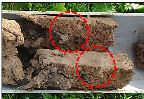
Figure 12 : Sondage n°3 – traces d'oxydation aux environs de 70 cm de profondeur (recouvrement >5%)
