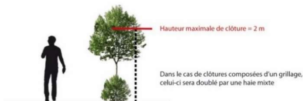
Clôture principalement composée d'un grillage
