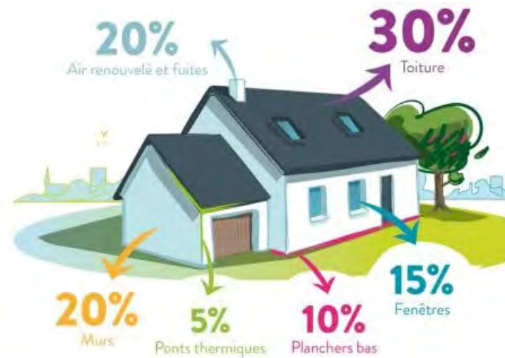
Schéma des déperditions thermiques d'un bâtiment . Source : calculeo.fr
