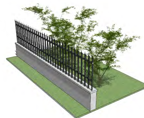
Mur bahut avec grille en fer forgé
