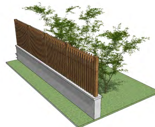
Mur bahut avec réhausse en lames verticales à claire-voie
