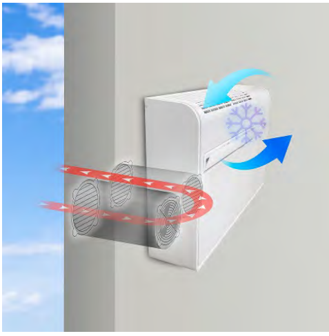
Schéma explicatif du climatiseur
