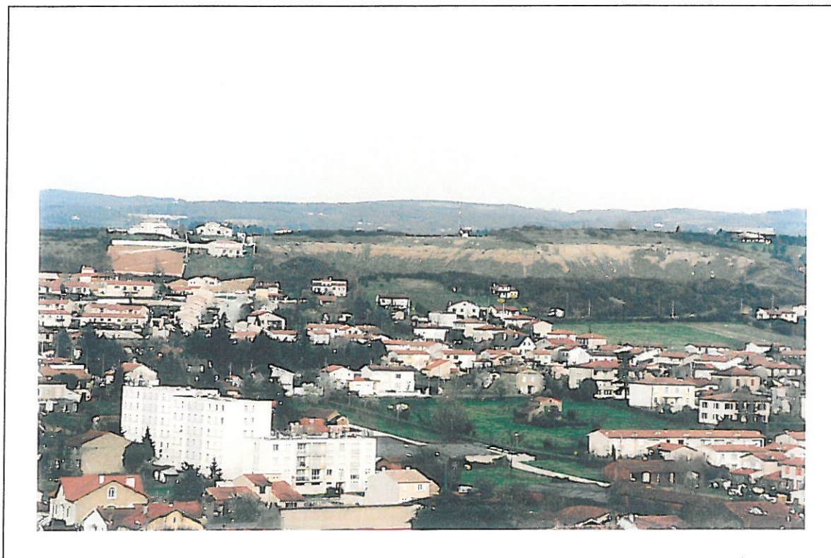
Photo 1 et 2 :Lieu-dit Roulandou à l'Ouest de Lardailé. Photo prise en mars 1999. Vue des collines molassiques et des argiles à graviers affleurant à leur sommet. Ces formations sont instables, particulièrement quand des aménagements de bâti les modifient dans leur structure. Le détail du deuxième montre le type de perturbations susceptibles de déclencher des mouvements de terrains : les murs de béton ancrés dans la pente ne peuvent pas remédier aux mouvements qui affectent le sommet de la colline où est construite cette habitation.
