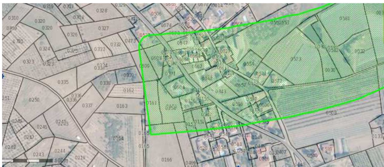
Figure 30 – Détail de la zone d'effondrements localisés faibles travaux supposés au niveau du hameau de Mulet (Site Cartélie, consultation du 15/08/2018).
