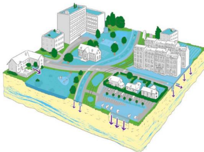
FIGURE 19 : ADAPTATION D'UN QUARTIER POUR LA GESTION DES EAUX PLUVIALES (SOURCE : AGENCE DE L'EAU RHIN MEUSE)
