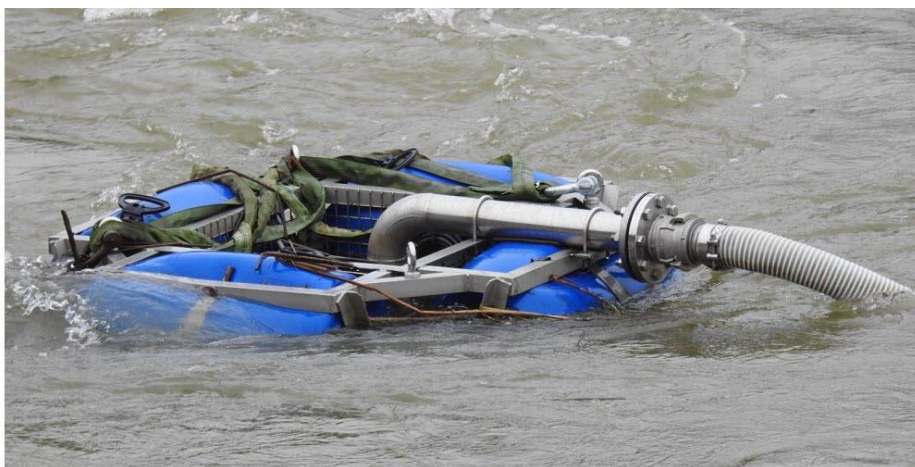
L'unité d'ultrafiltration mobile dans le Doubs sous le pont de Morteau (source : Est Républicain)
