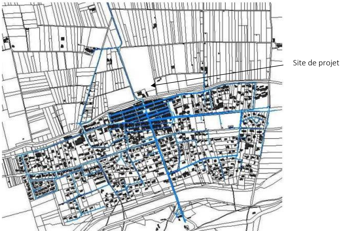
Extrait du réseau d'alimentation en eau potable.
