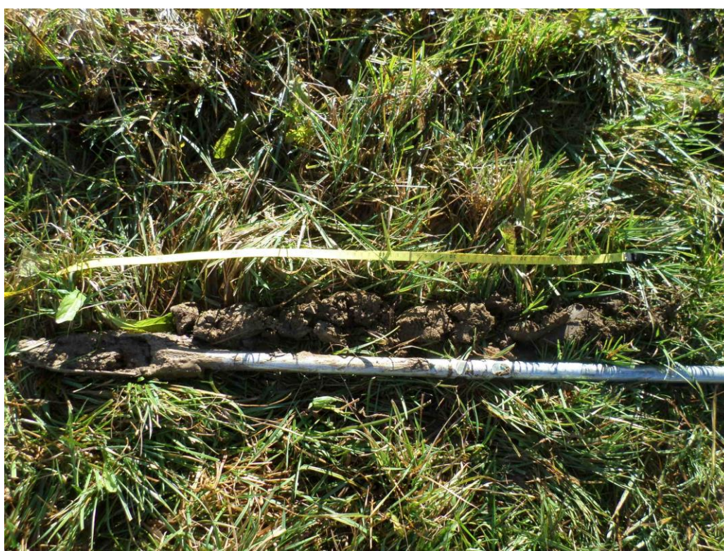
Exemple de carottage : Sondage n°3 : sol non humide (Epode novembre 2020) Présence de quelques traces d'oxydo-réduction et d'eau à partir de 70 cm
