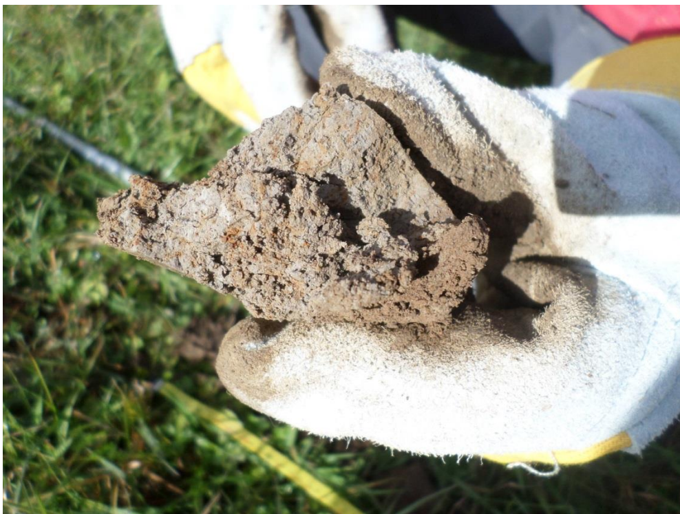
Exemple de carottage : Sondage n°12 : sol humide (Epode novembre 2020) Présence des traces d'oxydo-réduction et d'un horizon réductique
