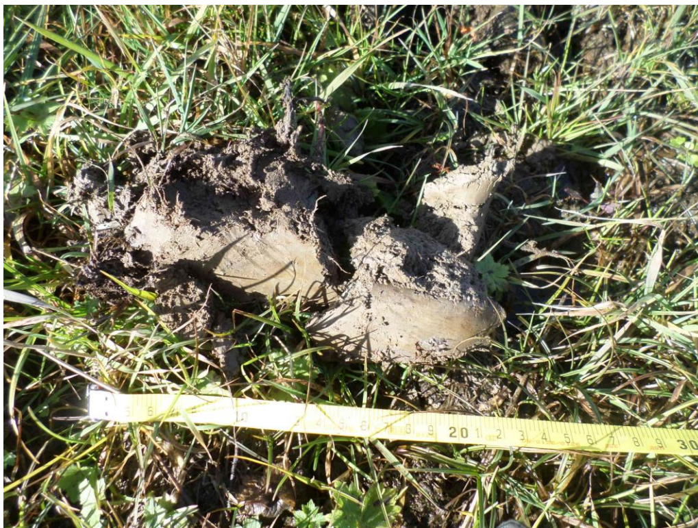
Exemple de carottage : Sondage n°9 : sol humide (Epode novembre 2020) Présence d'un horizon réductique
