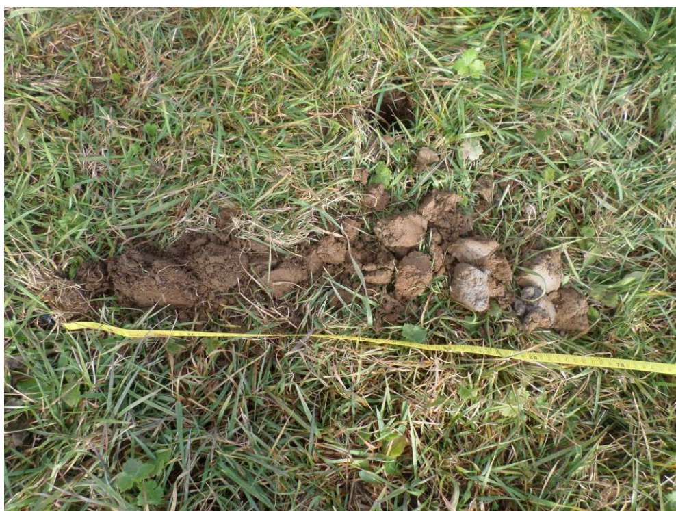
Exemple de carottage : Sondage n°12 : sol en limite de zone humide (Epode novembre 2020) Présence d'un horizon réductique à partir de 50 cm
