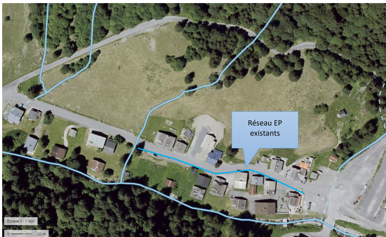
Figure 5 : réseau existant EP existant
