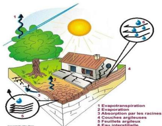
fig. 1 : illustration du mécanisme de dessiccation
