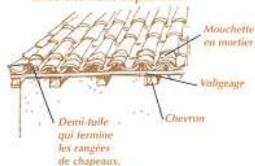
Egout de toiture avec chevrons dépassants
