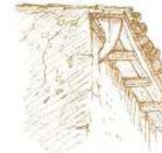
Support d'angle de la couverture dit "jambe de chevre"
