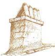
Souches de cheminées et couronnement traditionnel : tuiles creuses accolées.
