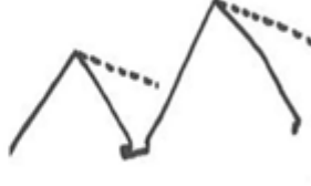
Raccordement entre deux toitures pignons
