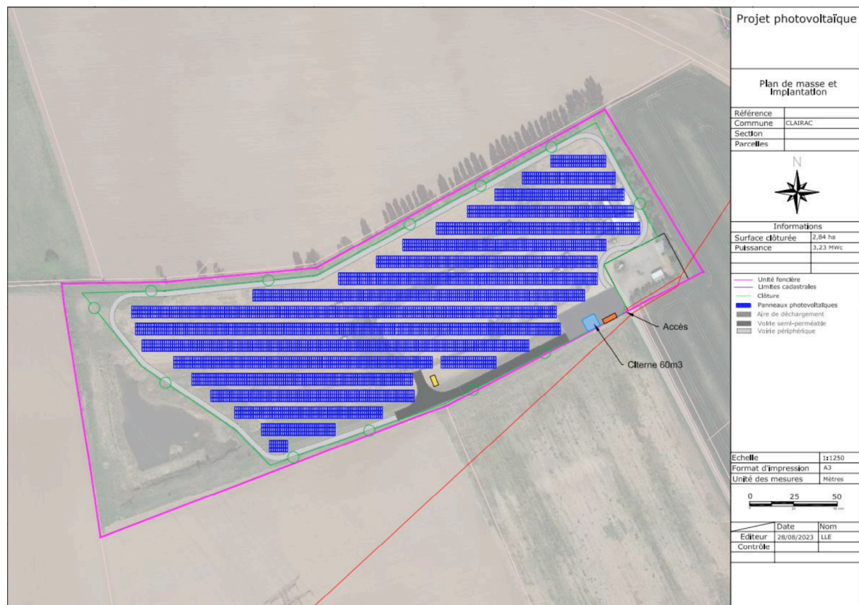
Illustration 20 : Plan de masse et implantation du parc photovoltaïque ; Luxel
