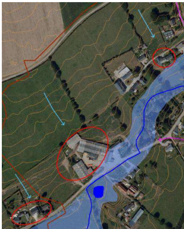
Figure 9 : Enjeux potentiellement exposés au ruissellement agricole (flèches bleues) sur la commune de Floursies [Source : IMSRN]
