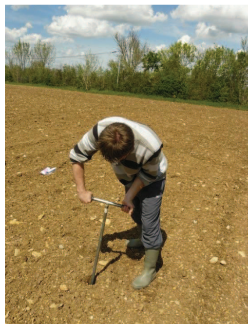
Traits d'hydromorphie (horizon rédoxique) et sondage pédologique en terre cultivée
