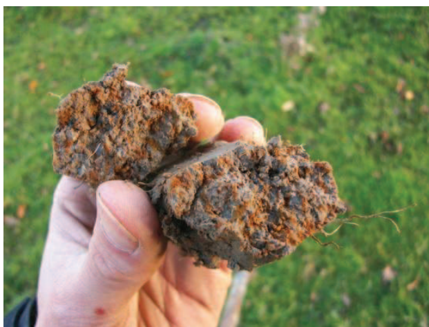
Traits d'hydromorphie (horizon rédoxique) et sondage pédologique en terre cultivée
