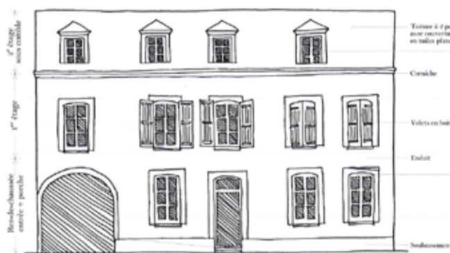
Sens / Maison de faubourg héritée du Moyen-Âge ayant évolué jusqu'au XVIIIe s. avec un accès sur rue qui dessert une cour à fonction utilitaire et qui distribue des bâtiments secondaires de réserve.*
