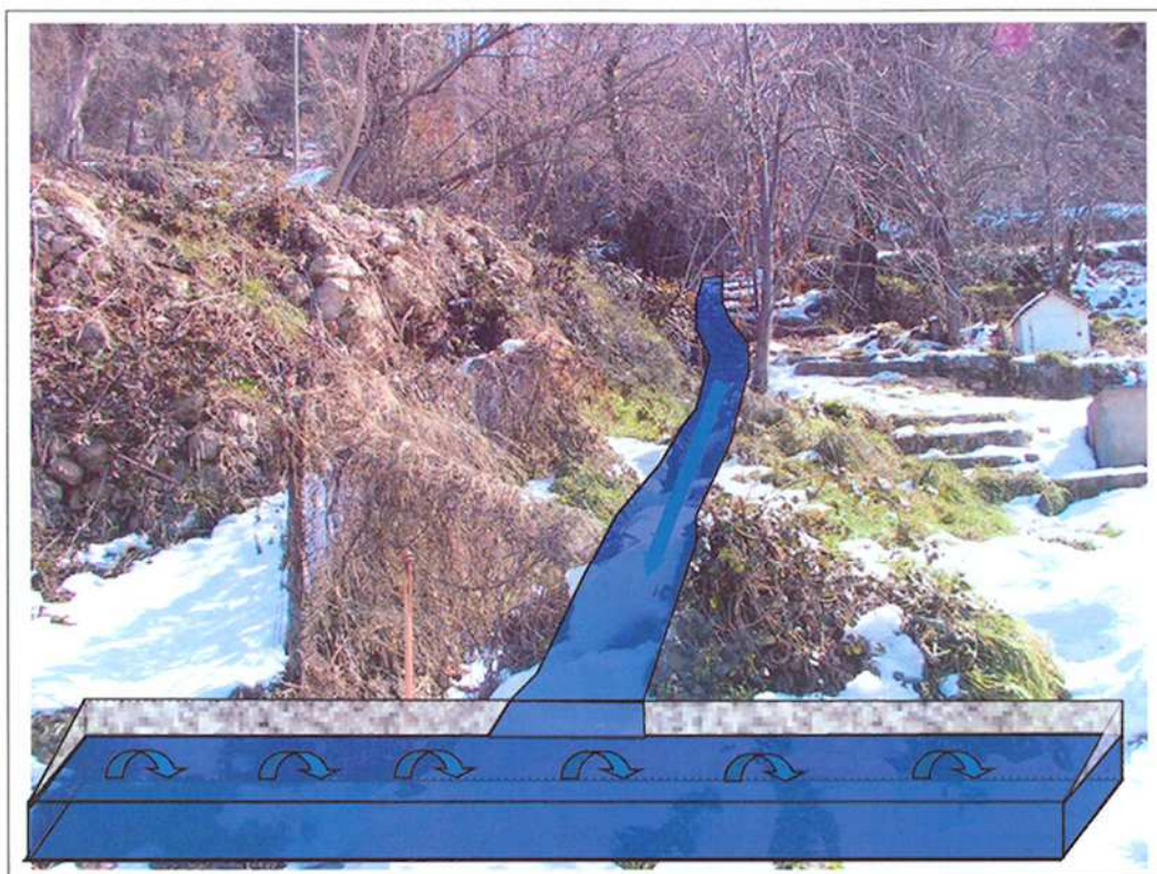
Photographie 10. Schéma de principe du canal avec son ouvrage de dissipation (vallon des Templiers sud).
