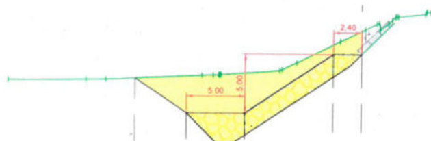
Illustration 8: Coupe digue Z.I. Carros - Le Broc extraite de l'étude de danger SETEC HYDRATEC de juin 2021
