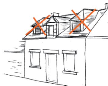
Les lucarnes à croupes et en chien assis, modifient la volumétrie initiale d'un bâtiment ancien, et ne correspondent pas aux typologies de lucarnes visibles sur Colpo.
