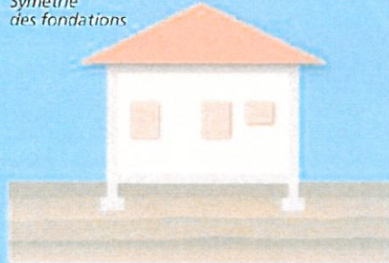
Dissymétrie des fondations
