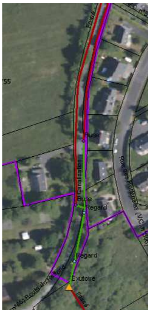
Figure 3. Partie canalisée route du Haffond
