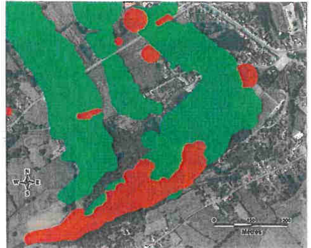
Figure 2 : Aléa effondrement localisé en 2018 à Bézenet suite à sondages, réexamen et travaux de sécurisation
