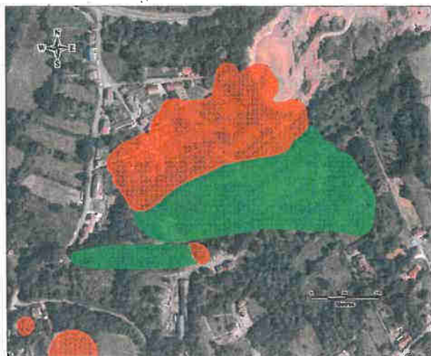
Figure 13 : Aléa effondrement localisé en 2010 à dans le quartier de la descenderie nord à Montvicq
