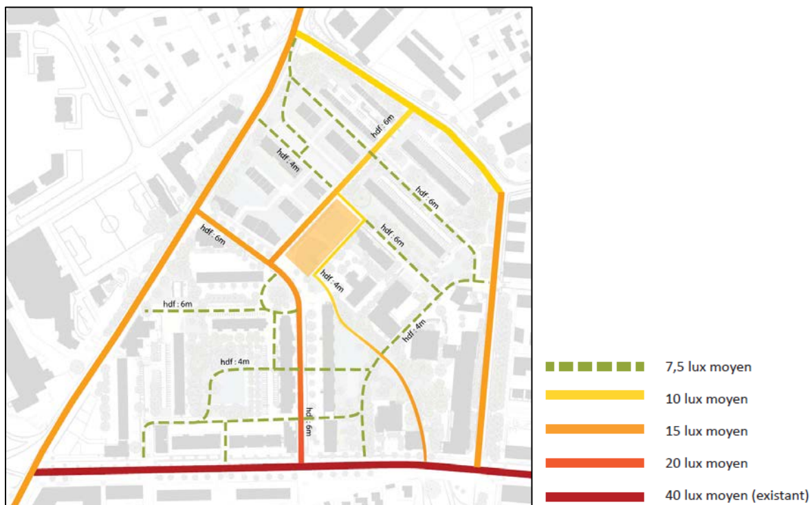
Figure 70 : Schéma d'intention des niveaux d'éclairage et des hauteurs de feux (Les Eclaireurs, AVP, Octobre 2021)
