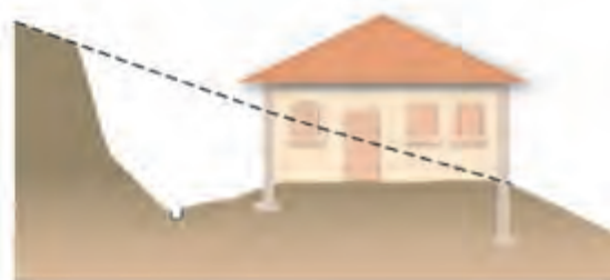
Plate-forme en déblais
