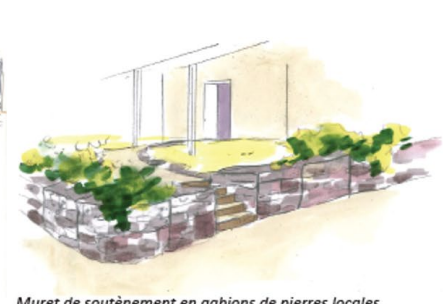
Muret de soutènement en gabions de pierres locales.
