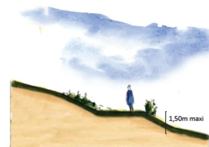
Principe de réalisation des talus végétalisés.
