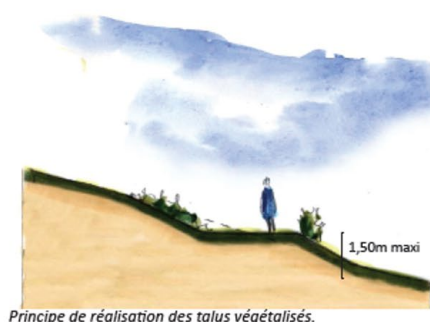
Principe de réalisation des talus végétalisés.
