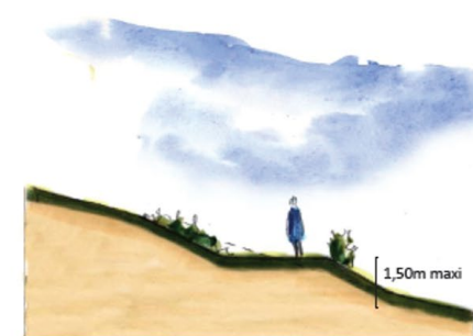
Principe de réalisation des talus végétalisés.
