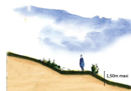
Principe de réalisation des talus végétalisés.
