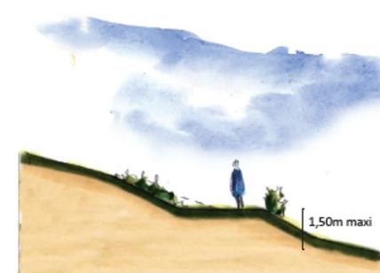
Principe de réalisation des talus végétalisés.
