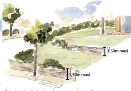
Principe de réalisation des murets de soutènement.
