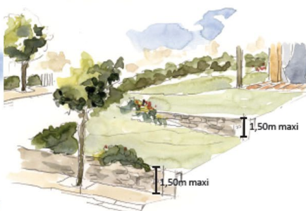
Principe de réalisation des murets de soutènement.
