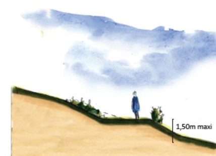
Principe de réalisation des talus végétalisés.
