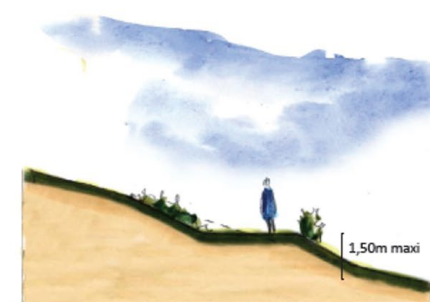
Principe de réalisation des talus végétalisés.
