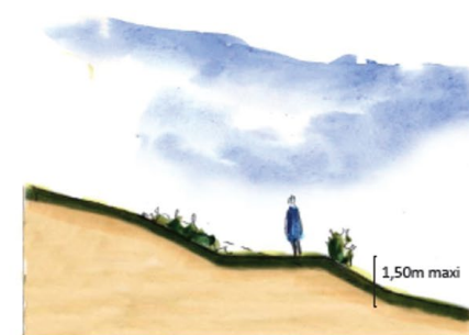
Principe de réalisation des talus végétalisés.
