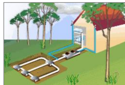
Schéma d'une installation individuelle. Source : MEEDM
