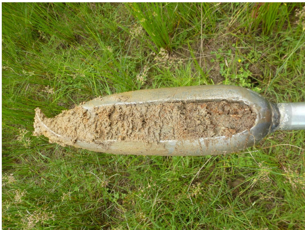
Photo 6 : Sondage S2 a 1 mètre du fossé
